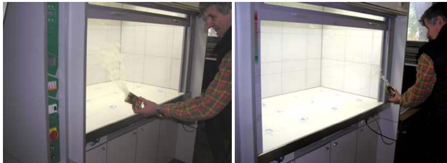
Слика 11. Визуелизација струјања ваздуха у равни заклона при отворености заклона од 600 mm
