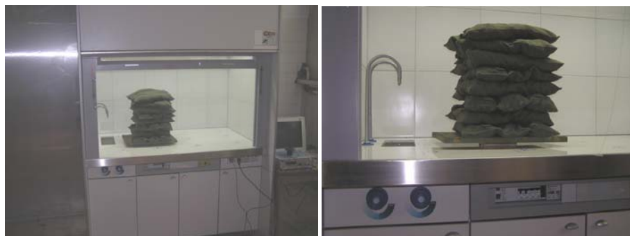
Слика 4. Испитивање отпорности радне површине на утицај статичког оптерећења
