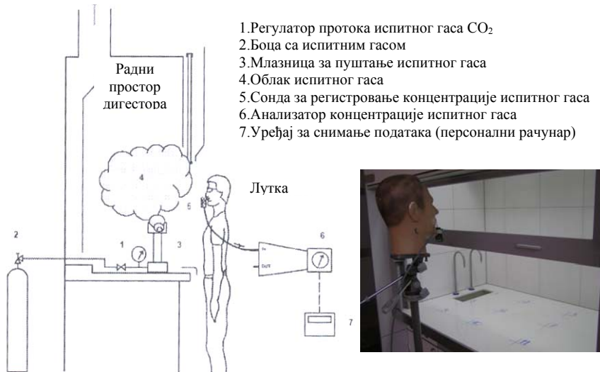
Слика 10. Скица мерења заштите околине радног простора просторије у који је смештен дигестор
