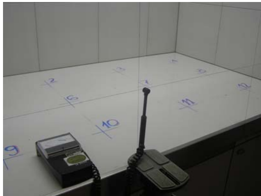
Слика 9. Мерење раванске брзине струјања, висина заклона 500 mm
