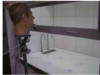
Слика 10. Скица мерења заштите околине радног простора просторије у који је смештен дигестор
